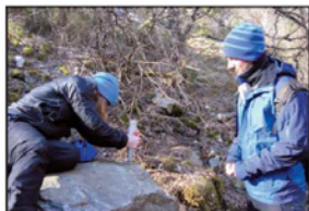
Her vert ei steinsprangblokk analysert med Schmidthamar.
